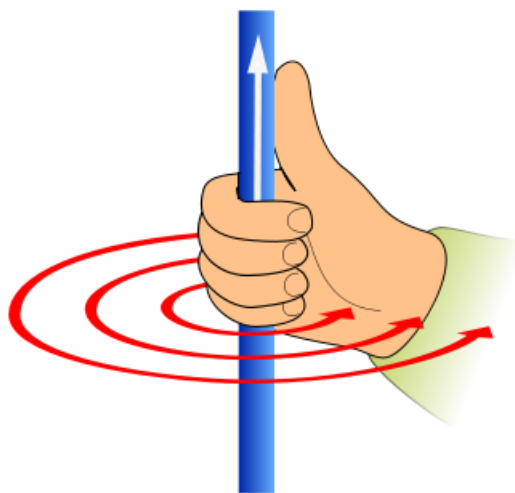
FIGURE 52.2 – La règle du pouce droit pour un courant dans un conducteur droit
