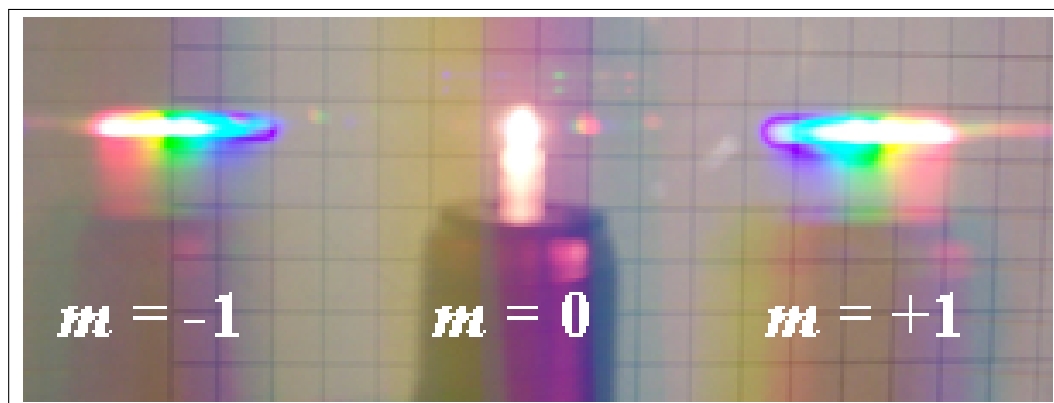
FIGURE 75.6 – Diffraction de la lumière issue d'une lampe "blanche" par un même réseau.
