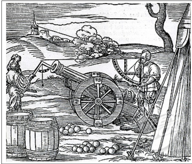
FIGURE 12.8 – Mesure d'angle de tir.
