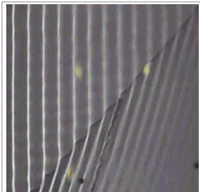
FIGURE 63.5 – Cuve à ondes à deux niveaux : le changement de niveau est en biais.
