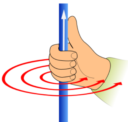
FIGURE 54.2 – La règle du pouce droit pour un courant dans un conducteur droit
